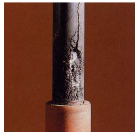
Поверхность полиэтилена (черного цвета) после испытания в течение 48 часов
